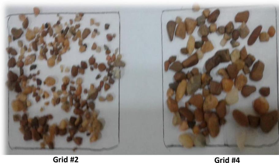
**Figura 2.** Muestras representativas de Grid #2 mm y Grid #4 mm.
