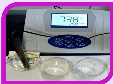
FIGURA 7: MEDICIÓN DE PH-METRO CON BICARBONATO DE SODIO.
