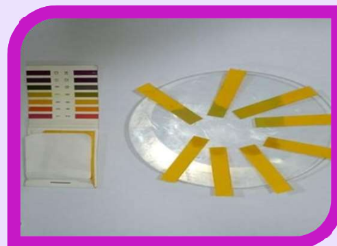
FIGURA 6: MEDICIÓN DEL PH EN CINTA CON BICARBONATO DE SODIO
